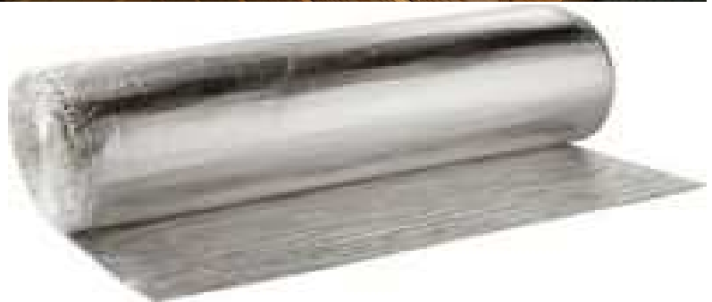
ISOLANT PLAFOND : Ep. 7 mm, classé M1 (CSTB.MRA 98-954-1/M3). 2 feuilles d'aluminium pur 12 microns, 2 films de bulles ignifugés M1 140 microns.
